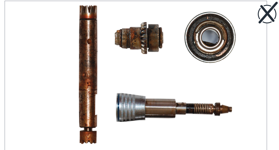
Piezas de mano con un mantenimiento incorrecto
